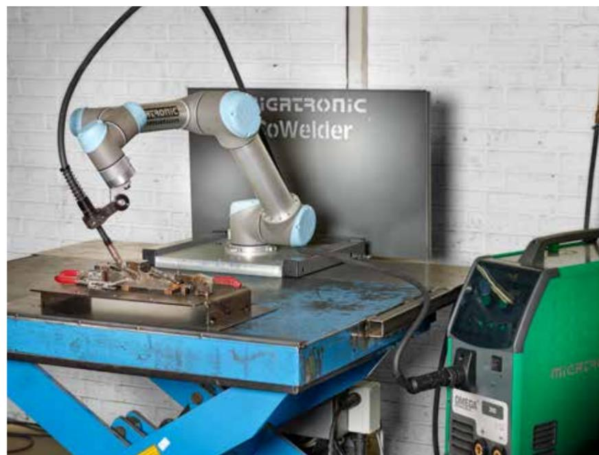
CoWelder™ est la solution de soudage automatisée la plus petite et la plus ingénieuse du marché. Elle est idéale pour le soudage de pièces simples, quelles que soient la quantité et la fréquence. Cette solution comprend une source d'alimentation Migatronix ainsi qu'un bras robotisé Universal Robots.
