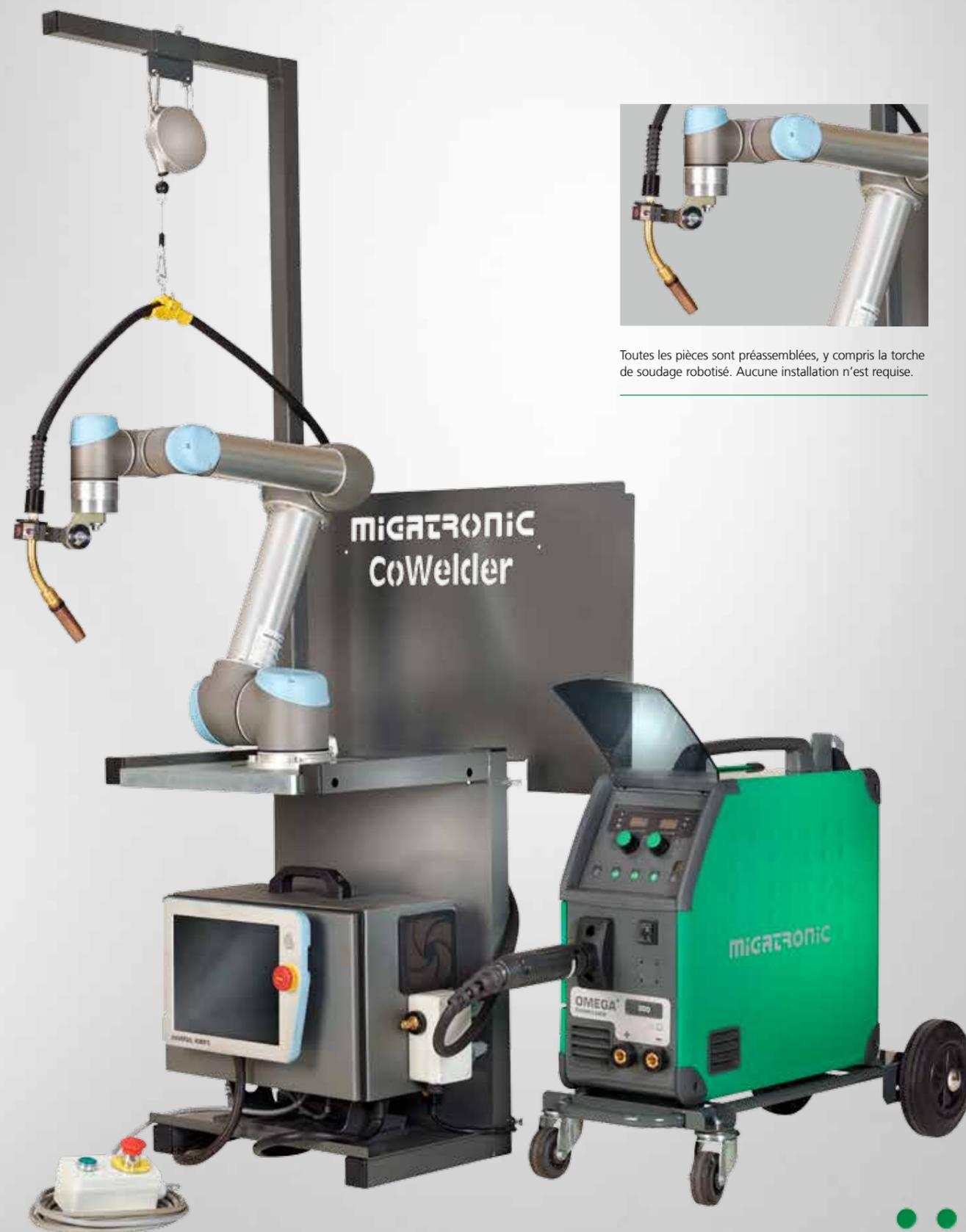
Toutes les pièces sont préassemblées, y compris la torche de soudage robotisé. Aucune installation n'est requise.
