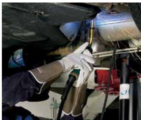
Réglage des paramètres de soudage sur la torche Dialog
