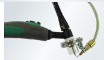
Guide-fil monté sur la torche de soudage.
