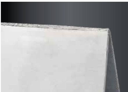
Tôle d'acier inoxydable austénitique de 1,0 mm d'épaisseur, soudée avec la fonction IAC.
